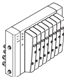
Встроенный узел fieldbus управляет связью с вышестоящим ПЛК. Это дает очень компактное решение, как по электрике, так и по пневматике.
