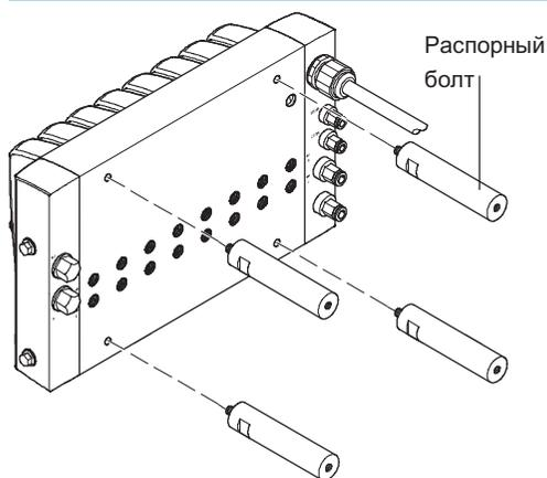
Пневмоостров CDVI может быть смонтирован непосредственно на заземленной монтажной поверхности с помощью четырех резьбовых отверстий в базовом блоке и распорных болтов (ножек), заказываемых при помощи кода заказа (код заказа принадлежности Y).
