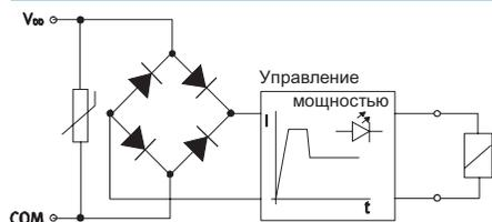
Каждая катушка распределителя защищена схемой гашения искры, а также от смены полярности.
