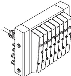
Сигналы управления от контроллера на пневмоостров подаются по многожильному кабелю с разъемом или под самосборку, что значительно сокращает время монтажа.
