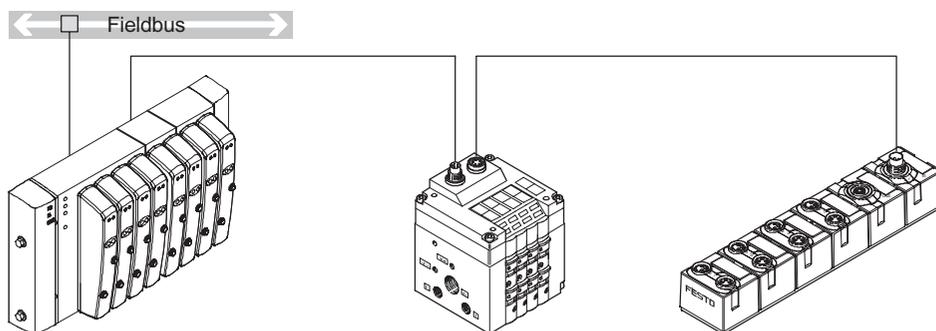
Пневмоострова CDVI-DN с интерфейсом fieldbus могут иметь 4, 6, 8 или 12 позиций распределителей и от 4 до 24 катушек.
